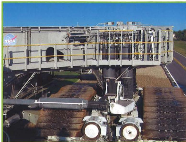
**01** Einbausituation der alten JEL-Zylinder in einem Fahrwerk
