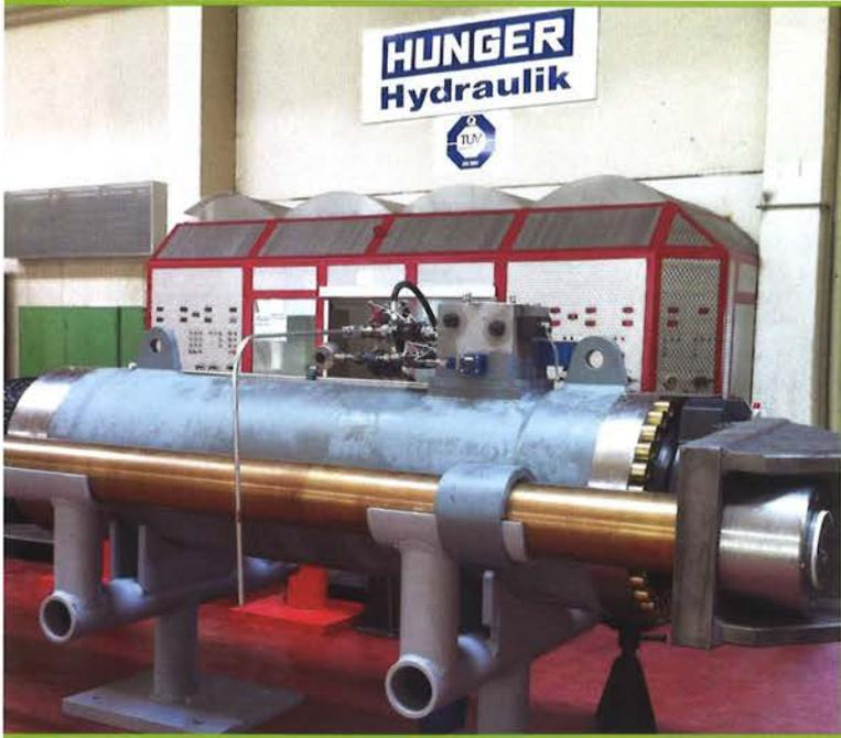
08 JEL-Zylinder im Lasthalterahmen auf dem Hydraulikprüfstand
